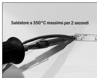
Figura 4. Saldatura dei cavi Utilizzare stagno senza piombo
