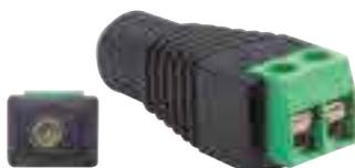
Composto da una spina coassiale diam. Int. 2,5mm e diam. Est. 5,5mm e un morsetto 2 poli a vite montato sul retro con polarità + e -.
