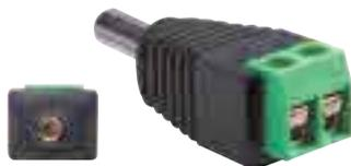
Composto da una presa coassiale  $\varnothing$  int. 2,1mm e  $\varnothing$  est. 5,5mm e un morsetto 2 poli a vite montato sul retro con polarità + e -.
