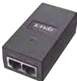
Iniettore PoE 10/100Mbps, permette la trasmissione di dati e alimentazione attraverso un unico cavo di rete Cat.5 o superiore sia a dispositivi abilitati PoE che a quelli non PoE, eliminando il problema di dover collegare un cavo di alimentazione ad una presa vicina.
