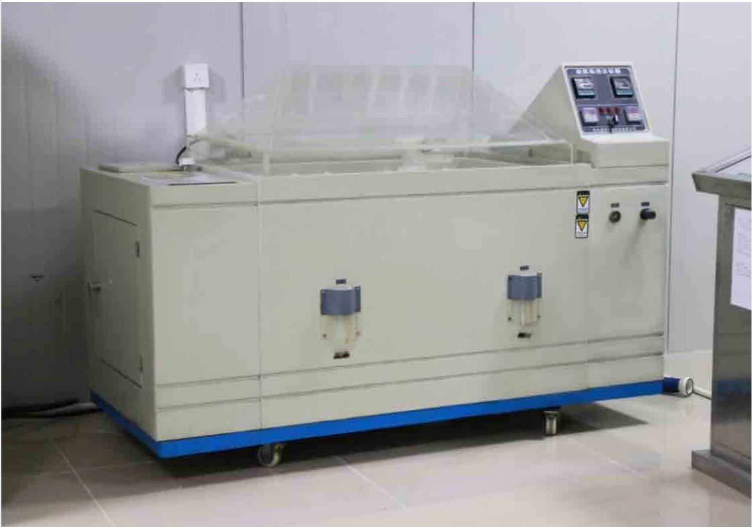
*Salt machine test- Verifica della resistenza dei materiali all'aggressione salina*
