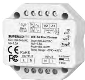
Adatto per la dimmerazione delle strisce LED a 220V. Possibilità di gestione tramite pulsante, radiocomando 13/22132-00, 13/22133-00, 13/22136-00 (NON inclusi) o app TUYA. Tensione di ingresso uguale tensione di uscita.
