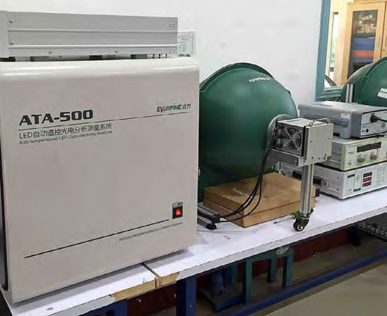
*Analizzatore di flusso in autovariazione di temperatura*
