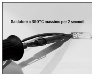
Figura 4. Saldatura dei cavi Utilizzare stagno senza piombo
