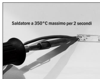
Figura 4. Saldatura dei cavi Utilizzare stagno senza piombo
