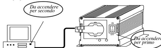
**ATTENZIONE:** Non invertite la polarità. Usate il cavetto rosso per connettere il terminale (+) alla batteria da 12 VCC e poi, usate il cavetto nero per connettere il terminale (-) alla batteria.
