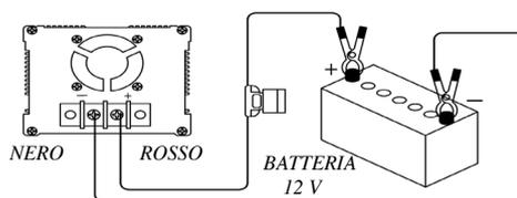
Durante il funzionamento, con l'interruttore di accensione in posizione ON, se l'indicatore acceso/spento non si illumina, controllate il fusibile nel cavetto della batteria. Se questo è guasto, sostituirlo con uno di pari amperaggio
